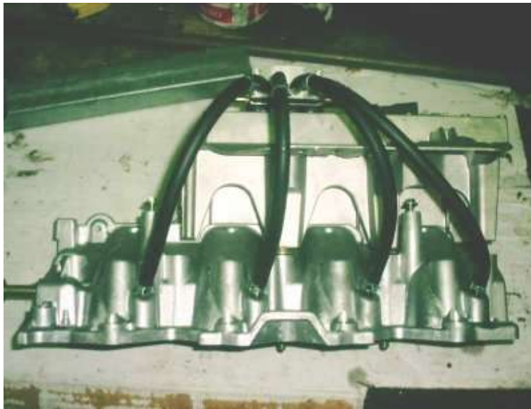
Distributeur, gicleurs GPL, pipe d'admission et damper assemblés, prêts à être remontés.
